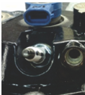
Пример использования серебристого центрирующего кольца
