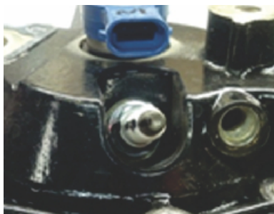
Пример использования медного центрирующего кольца
