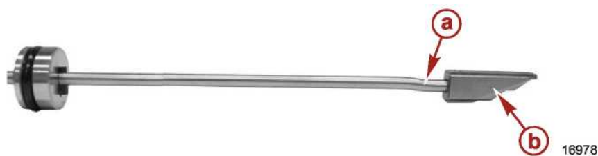
a - Изгиб вала переключения передач
