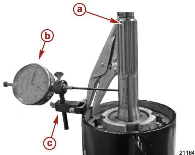
Установка для проверки биения вала гребного винта
