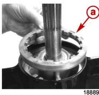
a - Гайка держателя несущего корпуса подшипника
