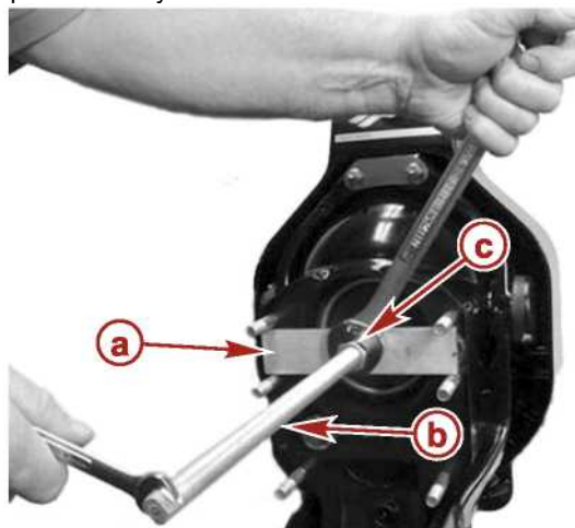
a - Пластина съемника c - Гайка и плоская шайба b - Резьбовая штанга (вал съемника) d - Обжимная гильза снята
