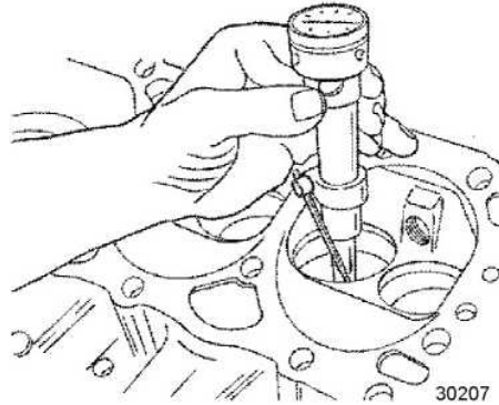
Измерение concentричности седла клапана
