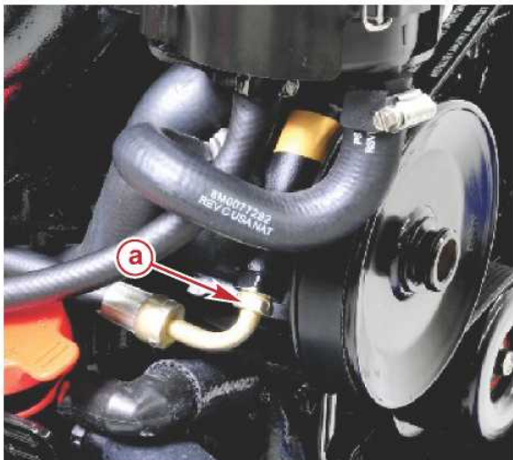
а - Шланг высокого давления (уплотнительное кольцо не показано)
