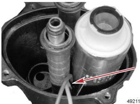
Провода между перегородкой
