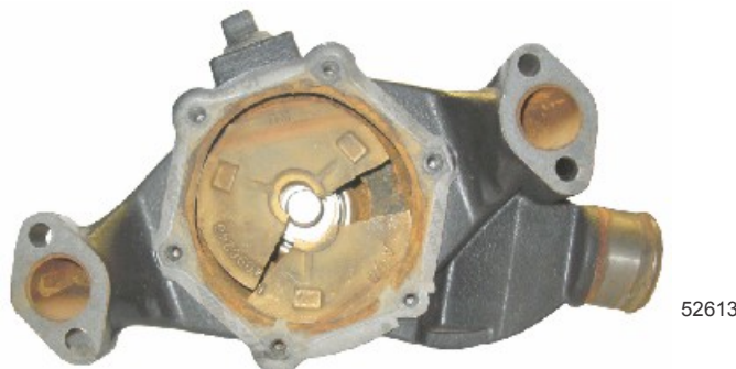
Потрескавшаяся крыльчатка циркуляционного насоса
