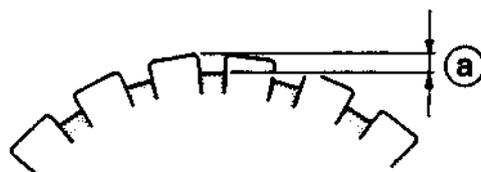
а - Измерение глубины межламельных канавок
