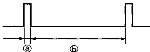
2. Индикация кода неисправности
