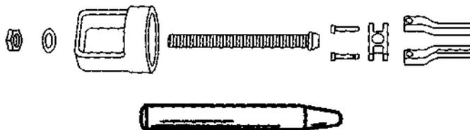
25. Инструмент для установки подшипников - Bearing Installation Tool (91-856875A1)
