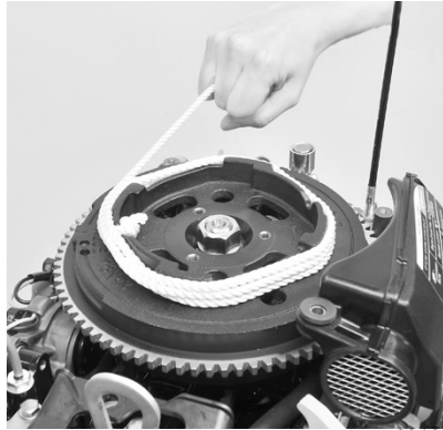
Трос аварийного пуска на маховике
